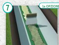
7 Poni il nastro di giuntura **BAND** e spandi su di essa la colla **GLUE** con l'aiuto di una spatola.
