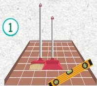
1 Pulisci la superficie e assicurati che essa abbia la pendenza necessaria per drenare.
