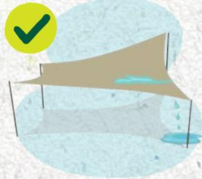
Installa la tenda con un'**inclinazione del 25-30%** per garantire una corretta evacuazione dell'acqua.
